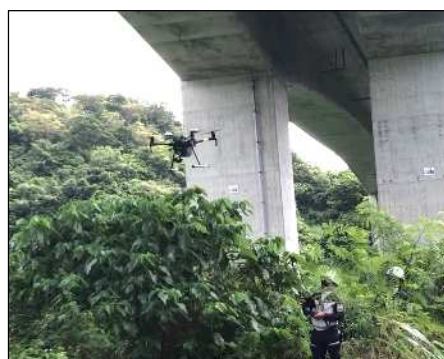
写真2 新技術_UAVを用いた画像解析技術の例
